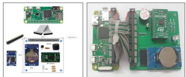
그림1. (좌) H/W 구성도, (우)완성된 경보기 하드웨어 예시
